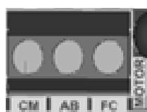
**OBS.:** Para motor monofásico é obrigatório que o fio “comum” do motor seja conectado no borne “CM” da central.
