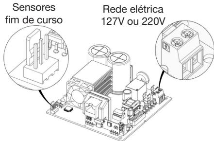
**OBS.:** Demais conexões como os fios do motor, sensor encoder, entre outros, já saem prontas de fábrica. Caso haja necessidade de alguma alteração, manutenção ou aplicação de módulos externos, consulte o manual completo para maiores detalhes.
