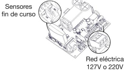
**NOTA:** Otras conexiones como los cables del motor, sensor encoder, entre otras, ya están listas de fábrica. Si es necesario realizar algún cambio o mantenimiento, consulte el manual completo para obtener más detalles.
