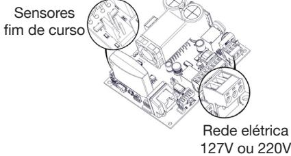
**OBS.:** Demais conexões como os fios do motor, sensor encoder, entre outros, já saem prontas de fábrica. Caso haja necessidade de alguma alteração ou manutenção, consulte o manual completo para maiores detalhes.
