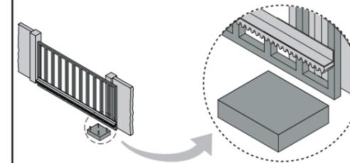
NOTA: El modo de fijación de la base lista es con plomo parabolit o plomo soldado (no incluido).
