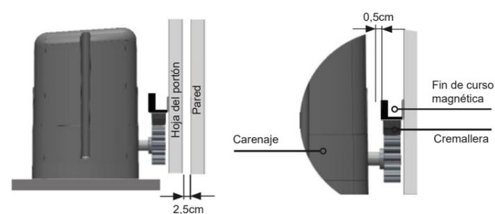
El final de carrera magnético debe quedar a una distancia máxima de 0,5 cm a partir de la cara externa del carenaje. La hoja del portón debe tener una distancia mínima de 2,5 cm de la pared.
