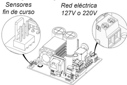
**NOTA:** Otras conexiones como los cables del motor, sensor encoder, entre otras, ya están listas de fábrica.
