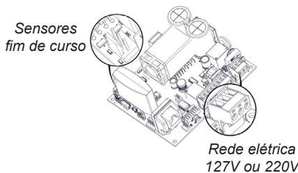
**OBS.:** Demais conexões como os fios do motor, sensor encoder, entre outros, já saem prontas de fábrica. Caso haja necessidade de alguma alteração ou manutenção, consulte o manual completo para maiores detalhes.
