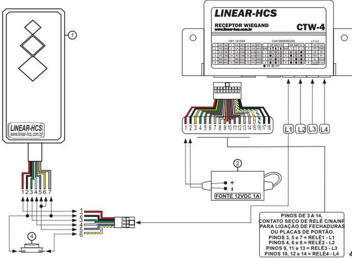
PINOS DE 3 A 14 CONTATO SECO DE RELÉ C/NA/IN/F PARA LIGAÇÃO DE FECHADURAS OU PLACAS DE PORTÃO.
