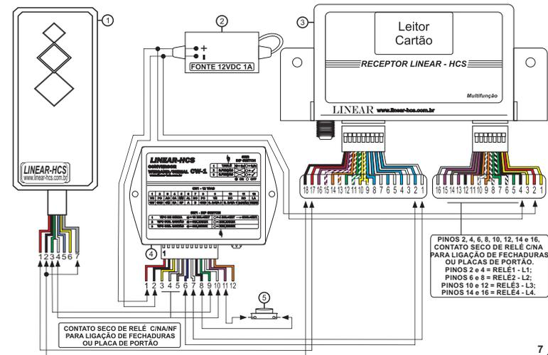
PINOS 2, 4, 6, 8, 10, 12, 14 e 16, CONTATO SECO DE RELÉ C/NA PARA LIGAÇÃO DE FECHADURAS OU PLACAS DE PORTÃO.
