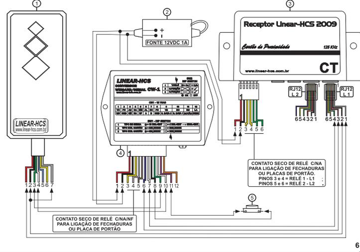
CONTATO SECO DE RELÉ C/NA/IN/F PARA LIGAÇÃO DE FECHADURAS OU PLACAS DE PORTÃO.
