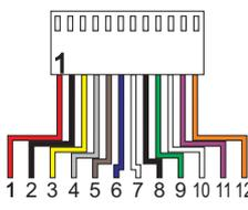
**NOTA:** PARA ACIONAR O RELÉ DO CONVERSOR ATRAVÉS DO BOTÃO AUXILIAR, LIGUE O BOTÃO (NA) AOS PINOS 8 E 11 DO CONECTOR CN-1.
