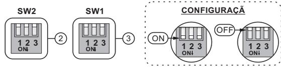
**IMPORTANTE:** As chaves de seleção 2 e 3 do Dip Switch SW2 não foram implementadas nesta versão do equipamento, para perfeito funcionamento mantenha-as em posição OFF.
