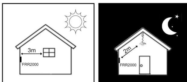
Certifique-se que o dispositivo está instalado em um local onde não fique com muita claridade atrás do rosto a ser identificado e a luz do sol não incida diretamente no dispositivo mesmo que passando através de uma janela.
