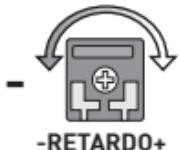
Para utilização de portão duplo, esta função causa um retardamento no acionamento entre os dois motores, sendo configurado através trimpot de retardo. Este recurso é limitado em 13 segundos no máximo.
