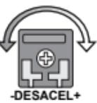
+ A desaceleração é utilizada para suavizar a transição entre a velocidade nominal do motor e a velocidade lenta (soft closing). Para regular a transição de desaceleração primeiramente ajuste o trimpot de DESACEL no valor máximo, em seguida pressione o controle remoto e verifique se o motor chega a parar antes de entrar na velocidade lenta, caso aconteça diminua de forma gradativa o trimpot de DESACEL e verifique novamente o percurso até encontrar uma transição suave.
