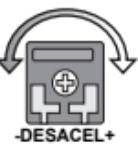
+ Se utiliza la desaceleración para suavizar la transición entre la velocidad nominal del motor y la velocidad lenta (Soft Closing). Para regular la transición de desaceleración primeramente ajuste el trimpot de DESACEL en el valor máximo, enseguida apriete el mando remoto y verifique que el motor llega a parar antes de entrar en la velocidad lenta, caso suceda, disminuya de forma gradual el trimpot de DESACEL y verifique nuevamente el recorrido hasta encontrar una transición suave.
