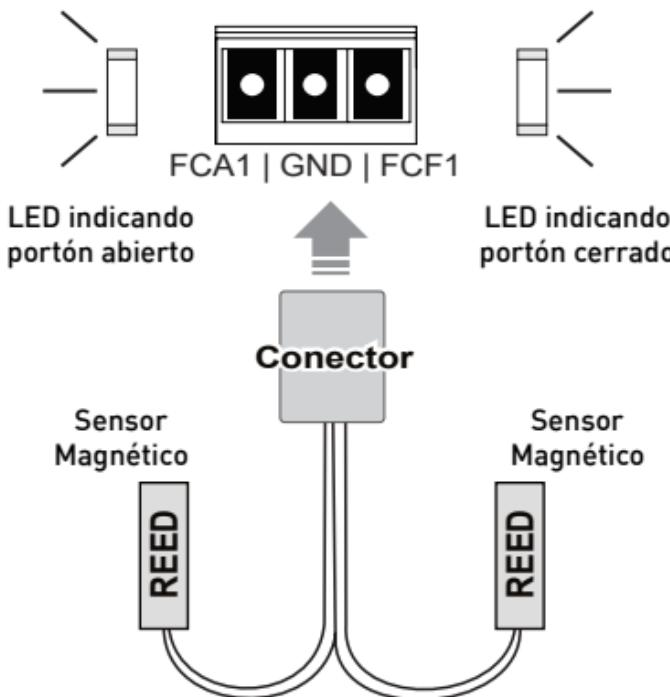
Para verificar que los bornes están correctamente accionados y funcionando, aproxime un imán al final del carrera (en el caso del reed ser magnético) o accione manualmente el final de recorrido, éste deberá encender el LED respectivo en la central electrónica (La CT22A solo acepta final de recorrido del tipo N.A. normalmente abierto).
