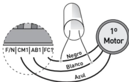
OBS: Los capacitores deben ser conectados a los cables negro y blanco, en los dos motores.
