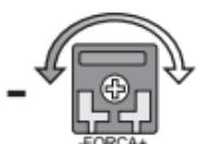
Esta configuración tiene como finalidad ajustar la potencia de salida para el motor, para que éste tenga torque suficiente para desplazar el portón durante su recorrido, así como no tenga torque suficiente para causar lesiones serias a una persona en contacto con el portón.
