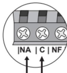
OBS.: La salida auxiliar (AUX) es solamente un conmutador (No hay tensión).
