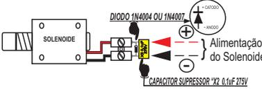
**FILTRO DE LINHA PARA FECHADURAS (Proteção Nível 3 – Aplica-se à corrente contínua ou alternada, Filtra e Retifica corrente AC para DC).**
