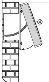
PASSE O CABO QUE SERÁ LIGADO AO CHICOTE DO LEITOR ATRAVÉS DO FURO CENTRAL DO SUPORTE, CONECTE OS CABOS E ISOLE-OS,
