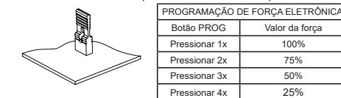
A força eletrônica deve ser ajustada através do JUMPER FORÇA. Coloque um jumper na posição FORÇA e pressione o botão PROG de acordo com o valor desejado, segundo a tabela a seguir.
