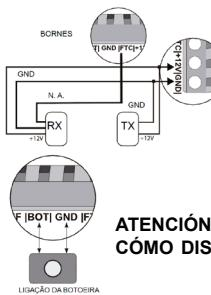
La central puede funcionar con cualquier tipo de fotocélula, desde que sus contactos sean del tipo "normalmente abierto".
