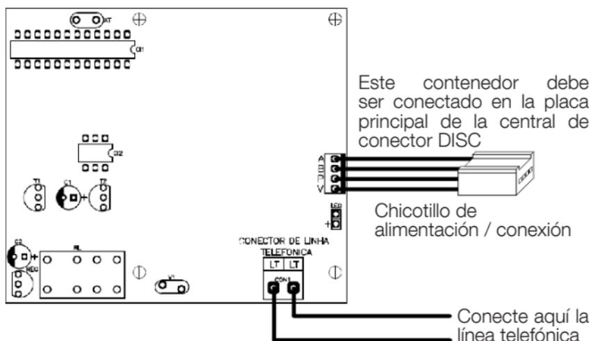
OBS.: En esta placa será necesario realizar solamente la conexión de la línea telefónica ya que la alimentación, armado/desarmado de las zonas y disparo del discador será realizado por el conector mostrado arriba. Haga sus instalaciones con la red eléctrica desconectada para evitar daños en el equipo y riesgos de descarga eléctrica en la instalación.
