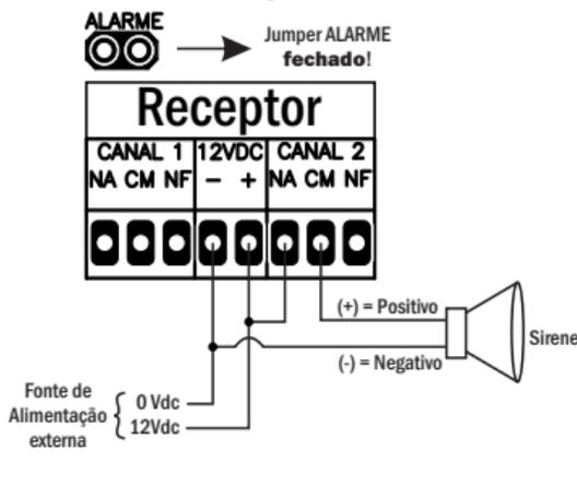
Ao pressionar o controle programado, a sirene irá emitir 1 beep para indicar "sistema armado" e 2 beeps para indicar "sistema desarmado". Ao receber o sinal do sensor sem fio, a sirene irá disparar pelo tempo programado caso o sistema esteja armado.
