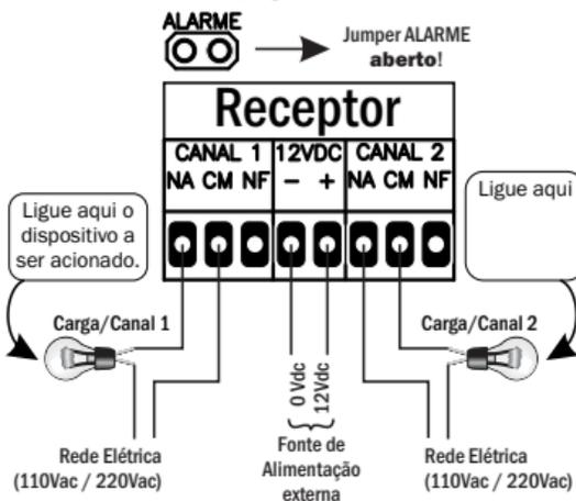
Neste modo os dois canais funcionam de forma independente. Basta pressionar o botão do controle remoto previamente cadastrado para cada um dos canais para fazer acionar a carga (neste exemplo trata-se de uma lâmpada). **Atenção: Configure o modo de funcionamento da canal para**
