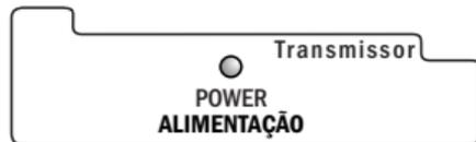
**ALIMENTAÇÃO / POWER:** este led indica que a unidade transmissora está alimentada e enviando os feixes de luz infravermelha à unidade receptora.
