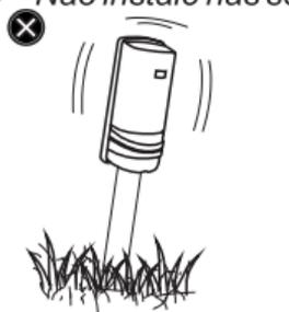
↳ Assegure-se de que a base onde o sensor será instalado esteja estável.
