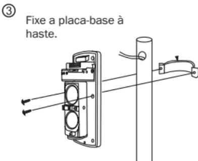
Diagrama de montagem traseira com traseira (dois transmissores).
