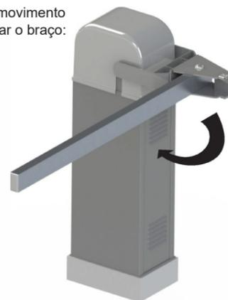
**NOTA:** O sentido de escamotear é definido durante a fixação do braço (barra). Você poderá alternar o lado de escamotear do braço invertendo a estrutura base. Basta soltar os 4 parafusos, inverter e fixar novamente (ver imagem abaixo):
