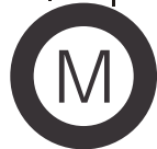
Motor Eléctrico Monofásico
